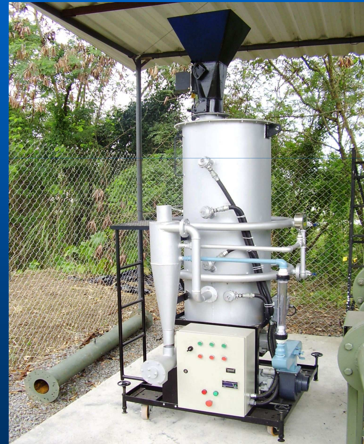
Prototipo II. Gaseificador de Biomassa Tipo Downdraft de duplo estagio de 25 kg/h
