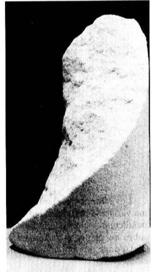
Fig. 6-11 Parte de un núcleo de una probeta de arenisca fracturada por torsión. (Experimento hecho por D. Pirtz.)
