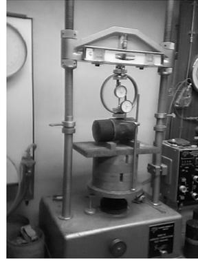
Figura 5. Prensa de CBR adaptada
