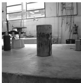
Figura 4. Probeta de suelo cemento adherida a probeta de hormigón hidráulico
