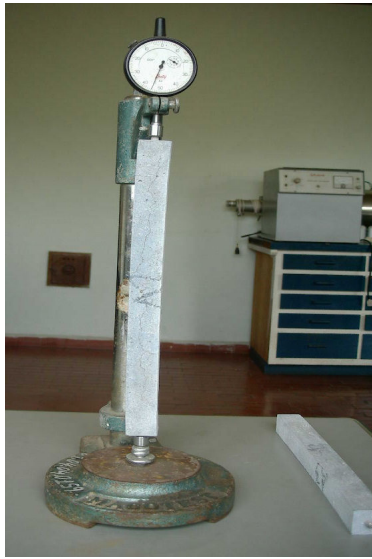
Figura 4. Se observa la forma de medir las probetas
