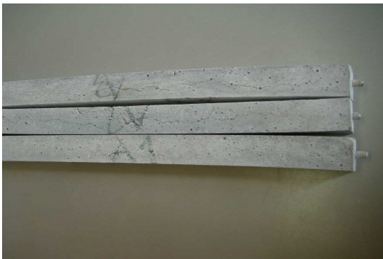
Figura 5. Se observa las fisuras y la deformación de las probetas luego del ensayo. Corresponde a la cantera Puerto Cinco de la Ciudad de Ayolas.
